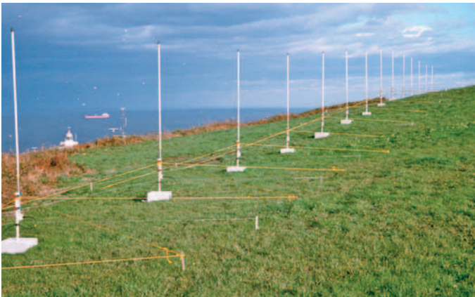
Das Über-Horizont-Wellenradar WERA der Fa. Helzel Messtechnik ist ein ozeanographisches Fernerkundungssystem zur Messung von Meeresströmungen, Wellen und Wind bis in 200 km Entfernung
