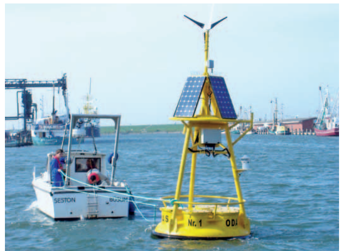
Eine der drei Ocean Data Acquisition Systeme (ODAS-Boje, geliefert von -4H-JENA engineering) zur Ermittlung wichtiger ozeanografischer Daten rund um die Halbinsel Eiderstedt
